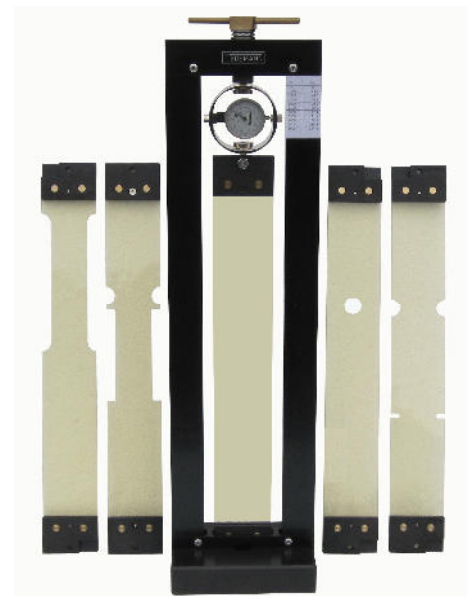
Zugbelastungsrahmen mit Ringkraftmesser und fünf Modellen
