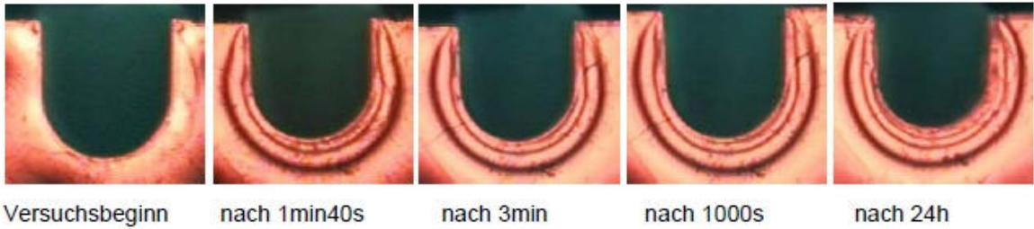
Spannungsaufbau durch die Aushärtung von Kompositmaterial in der idealisierten Zahnkavität (Dissertation Kristin Klinger, 2004)
