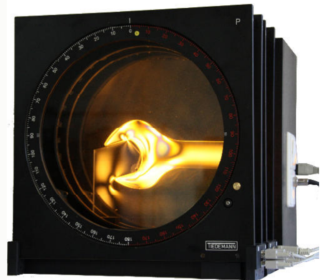
Tiedemann Polariskop AE131 mit jeweils motorisch angetriebenen Polarisator, Analysator und zwei Viertelwellenlängenplatten
