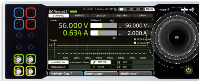
Afb. 2: elneos six met 8" beeldscherm en Airwheel met tactiele feedback
